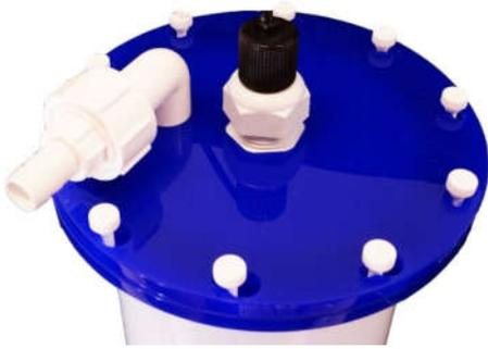
3. Remova da tampa o reator e a peça de acrílico, que serve com tampa quando não está instalado tubo de leds. Atenção ao oring que prende essa peça, ele deverá ser usado na montagem do tubo de leds.
